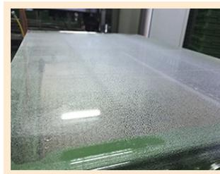
Figure 1 : Homogénéité de la taille des gouttelettes de la buse plate
